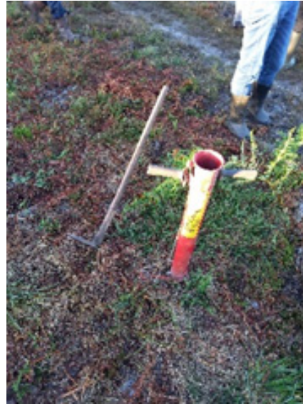
より簡単に木が植えられるよう工夫された道具。パイプに苗を入れ、ポンプを使って植樹を行います。
